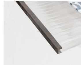
18. Über das Anti-Dust-Tape wird das Alu-Abschlussprofil mit den Ablaufbohrungen geschoben und auf der Oberseite mit Silikon abgedichtet. Weiße Abschlussprofile sind bauseits zu bohren.
